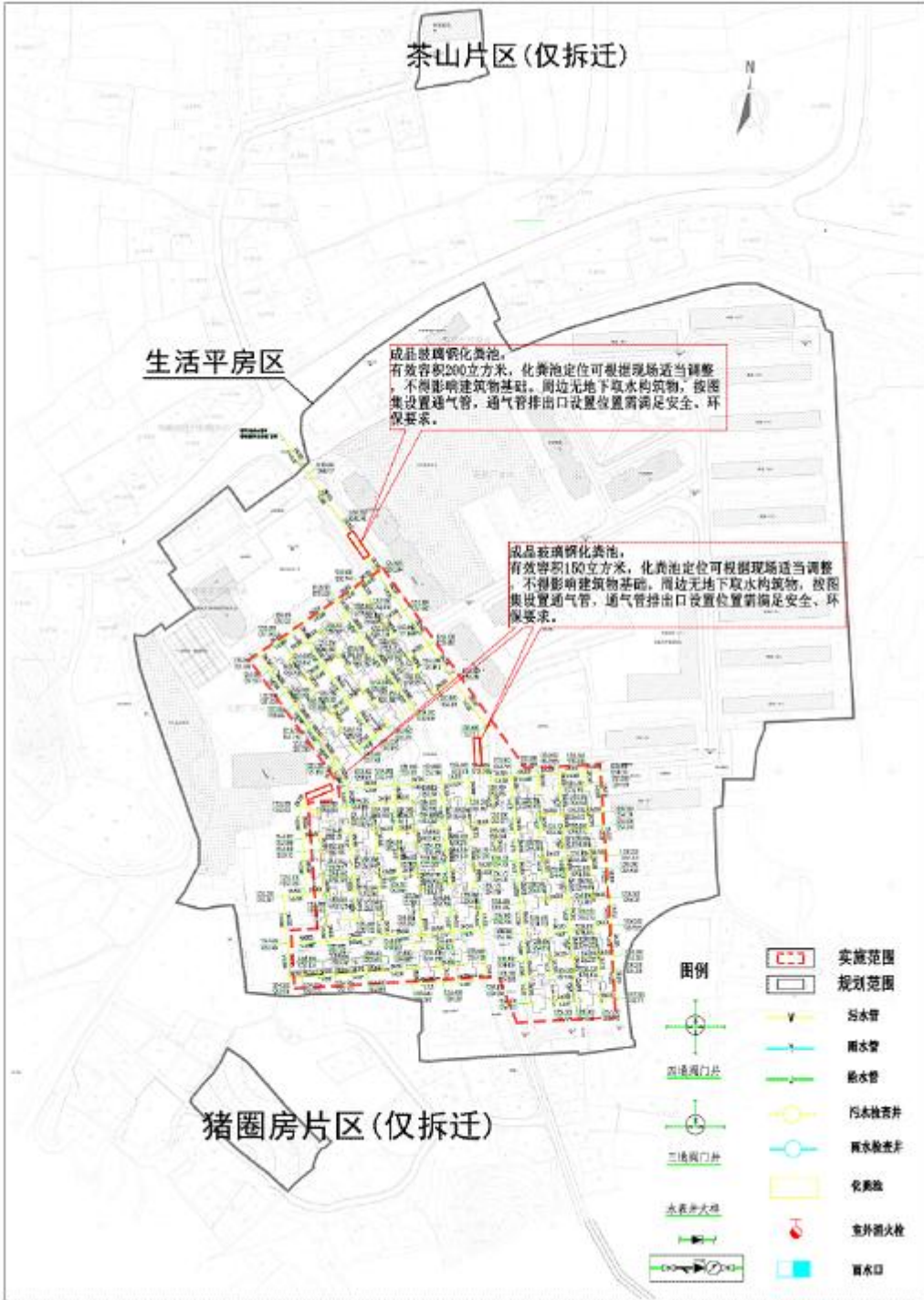
附图5 项目污水管网总图
